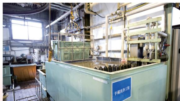
マイクロバブル超音波洗浄制御装置
