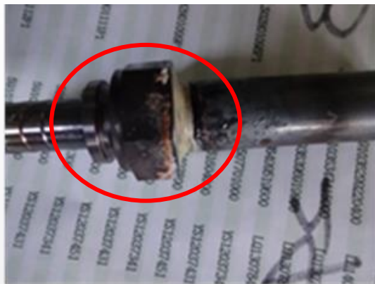
洗浄前の素材 フラックス・酸化スケールが付着している
