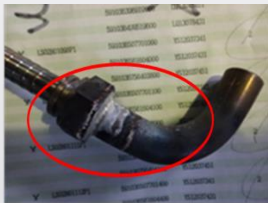
洗浄前の素材 防錆処理油膜・酸化スケールが付着している
