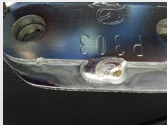
不具合事例 併せ面からの液だれ
