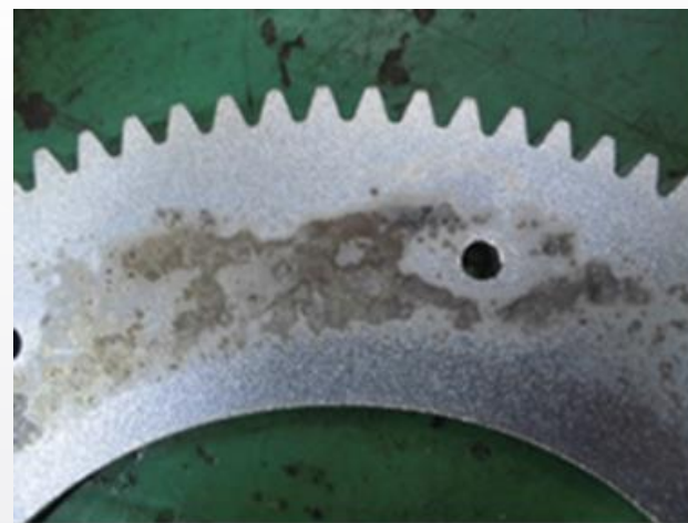
不具合事例 難素材から染み出し
